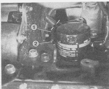
Выключатель давления масла (2) со своим разъемом (1) находится рядом с масляным фильтром.
