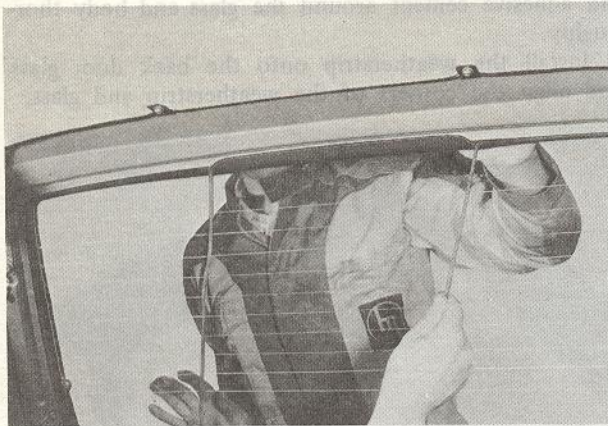
Fig. 14A-21 Pulling string
