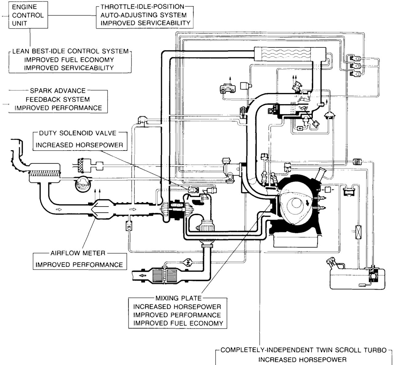
**EMISSION CONTROL SCHEMATIC DIAGRAM**
